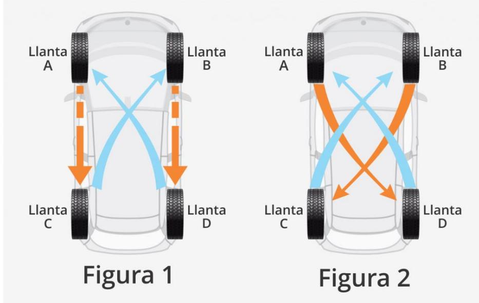
**Rotación de 4 Ruedas para vehículos con tracción trasera.**
