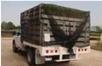
Malla sombra cubriendo la estructura metálica del camión para evitar la deshidratación de las plantas.
