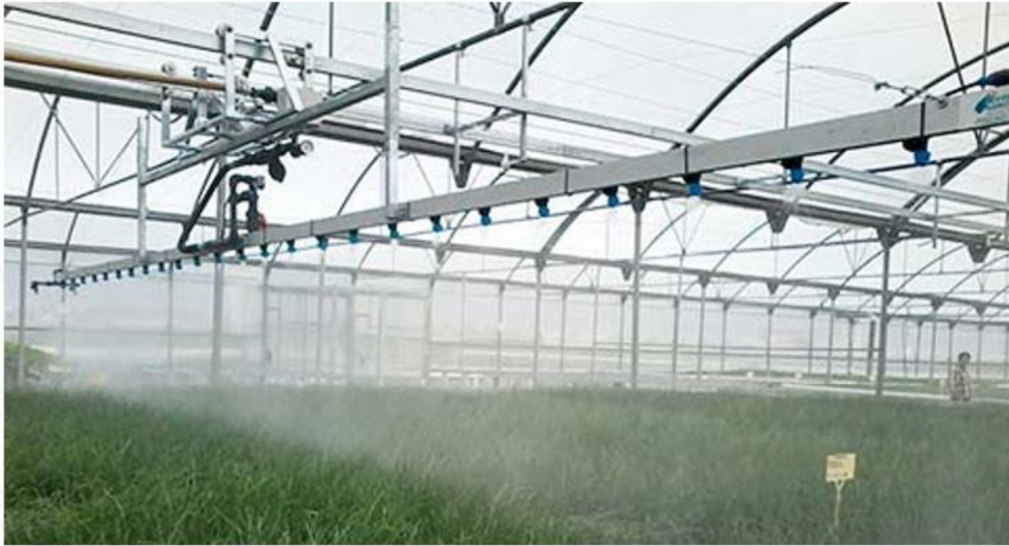
Imagen 3. Sistema de riego con robot aguilón suspendido.
