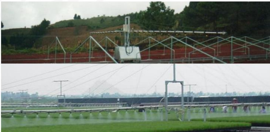
Imagen 4. Sistema de riego con robot aguilón sobre rieles.
