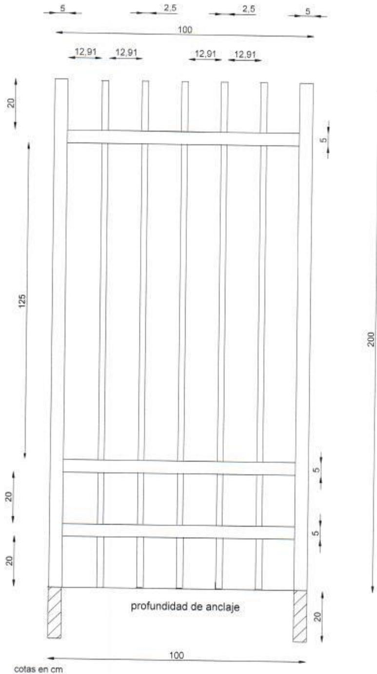
material: Tubo de 2 y 1 pulgadas de diametro acero al carbon acabado con primario anticorrosivo y pintura de esmalte alquidalico color gris acero metalico.
