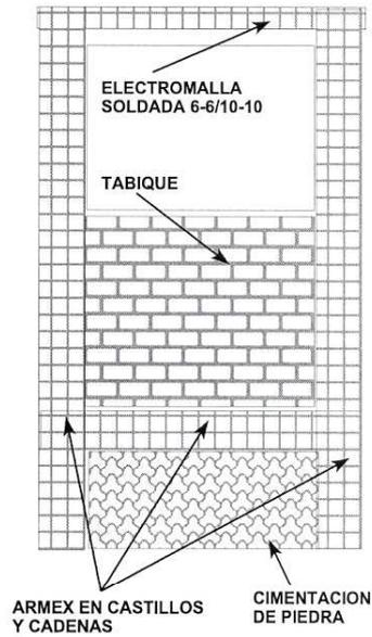
MURETE DE TABIQUE Y LOSA DE CONCRETO PARA LA PROTECCION DEL EQUIPO DE MEDICION
